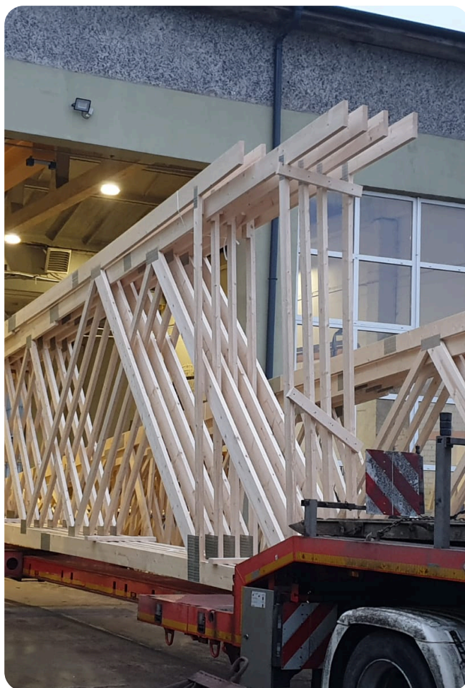
Asna de cobertura a sair da fábrica
